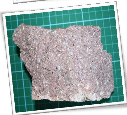
Abb. 8/9: Rhyolith oben aus dem Steinbruch Terpitz (stark alteriert) und unten aus dem Steinbruch am Eulenberg.
