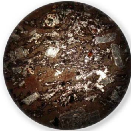
Abb. 16 Textur und Mineral-Inventar der Probe 1 im Überblick (Durchlicht)
