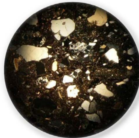
Abb. 17 Textur und Mineral-Inventar der Probe 2 im Überblick (Durchlicht)
